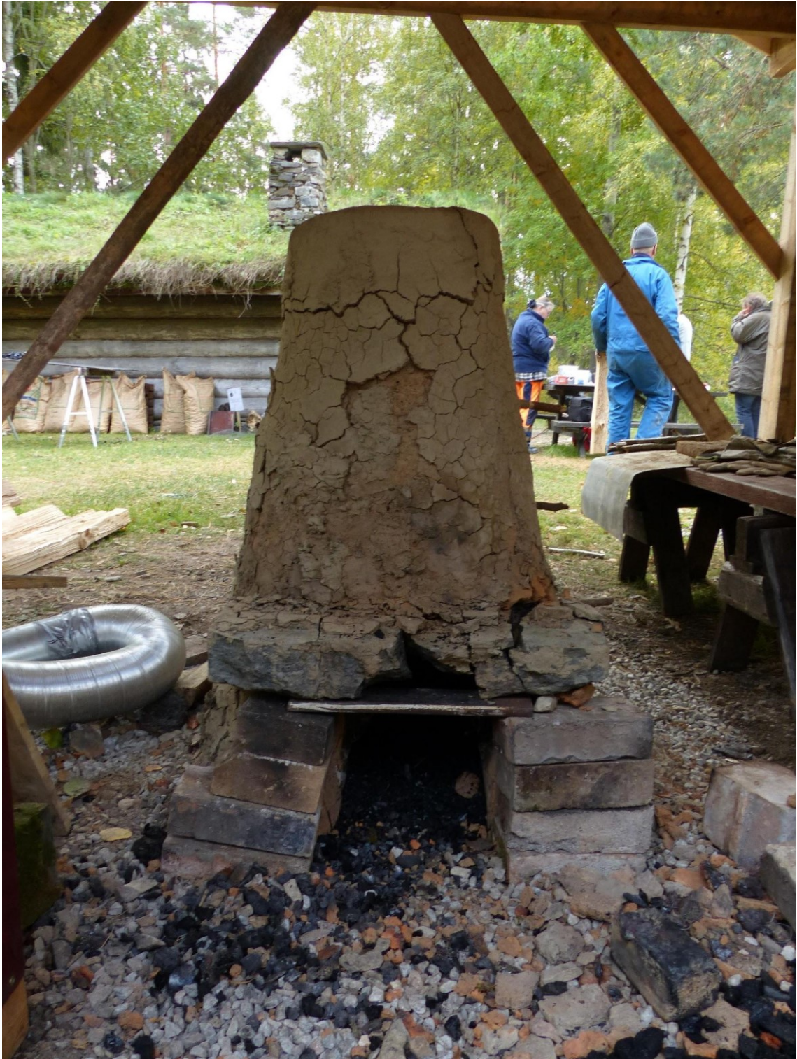
154. Bild på blästugn, från försök med förhistorisk järnframställning i Norberg. Foto - Karin Beckman-Thoor.
